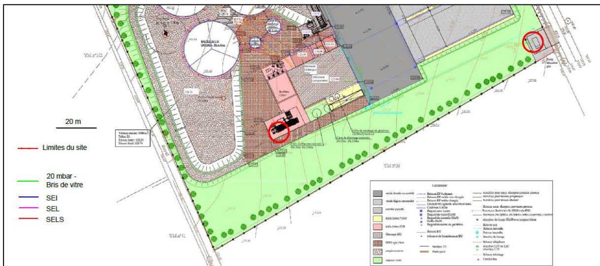
Figure 10 : Cartographie des effets du phénomène dangereux PhD4a : Flash-Fire suite à rupture de la canalisation biogaz entre l'unité d'épuration et le poste d'injection
