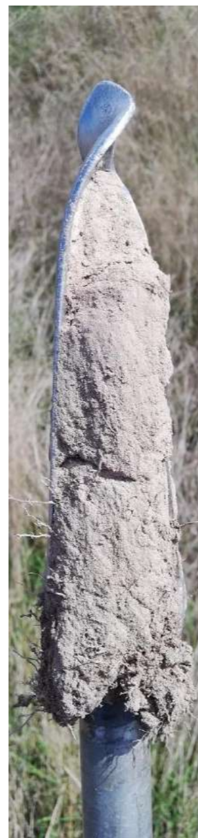
0 cm-20 cm, sondage en prairie au centre de la ZIP, non humide, refus 20 cm
