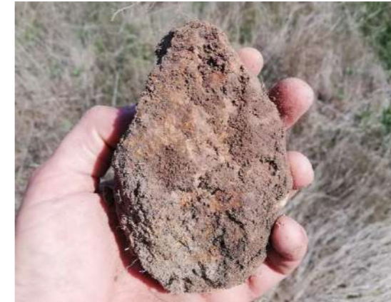
Photographie 6 : Silex, présent en lit dense à 20 cm et provoquant un refus de tarière (source : Ouest Am')
