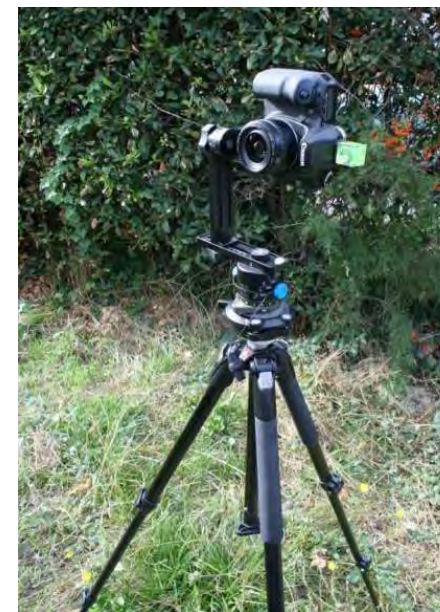
Figure 1 : dispositif d'acquisition d'images en séquence panoramique
