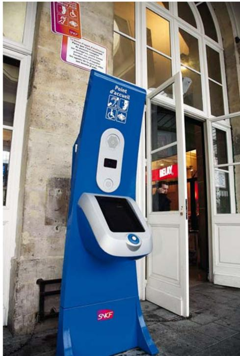
Borne d'appel accessible : balise sonore pour repérer l'équipement, appareil vocalisé et commandes contrastées visuellement et tactilement
