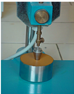
Figure 9 Détermination de la limite de plasticité au cône (à gauche) et à la coupelle de Casagrande (à droite) (Source Cerema)
