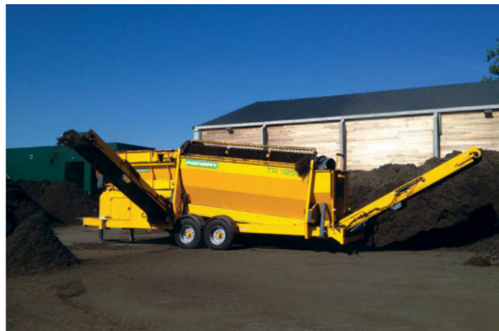
Figure 2 : exemple de crible rotatif pouvant être utilisé dans le cadre du tri des matériaux à restitué à la rivière.
