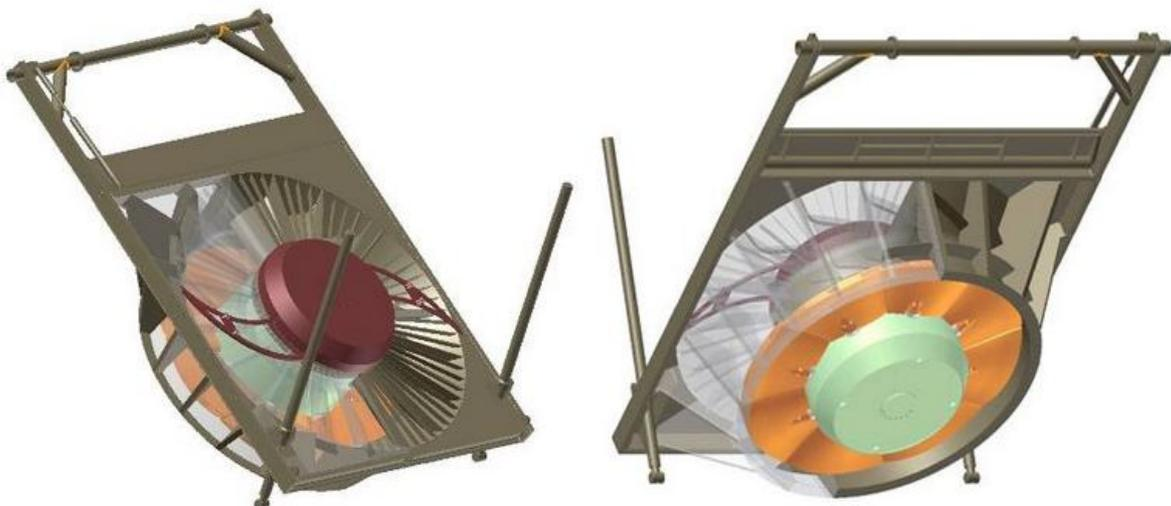
Figure 21 : vue de face et de dos d'une turbine VLH.
