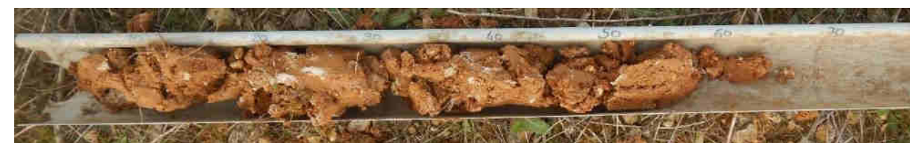
Profil pédologique au niveau de la carrière avec fragments calcaires altérés (taches blanches)
