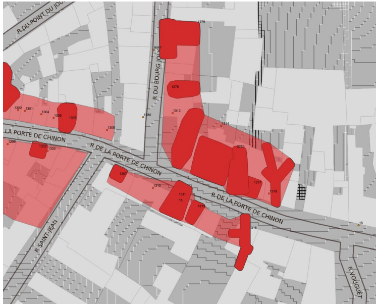
Illustration 25 : exemple du zonage des zones à présomption de présence « Très probable » s'appuyant sur l'emprise des cavités connues et levées avec un tampon de 1 m.
