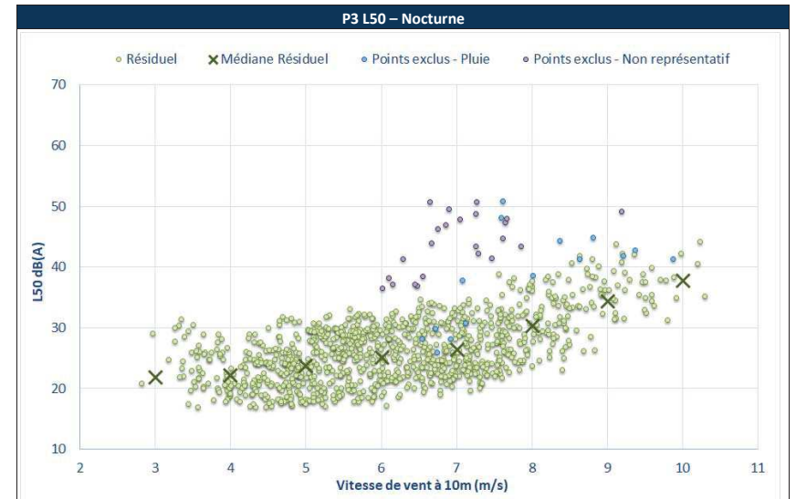
Figure 7 : Bruit en fonction de la vitesse de vent standardisée au point P3
