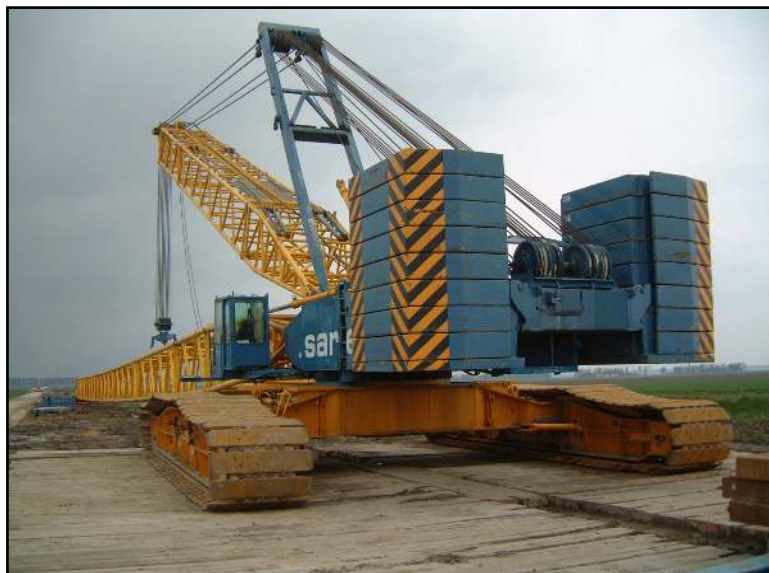
Photographie 6 : Photo de la grue permettant l'assemblage des différents éléments d'une éolienne
