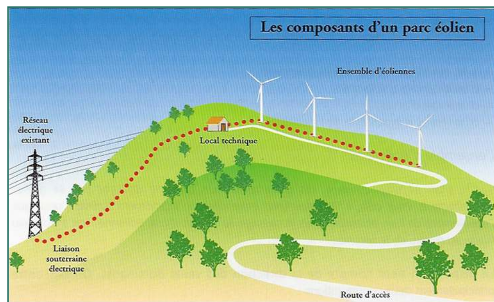
Figure 5 : Les composants d'un parc éolien
