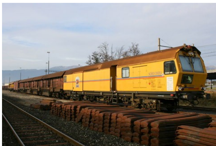
Train meuleur de rails (Scheuchzer S.A.)
