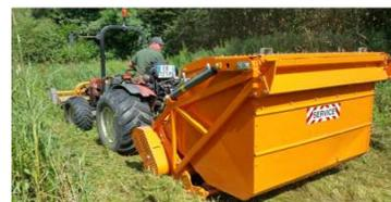
Exemple de matériel utilisé pour réaliser un broyage avec export
