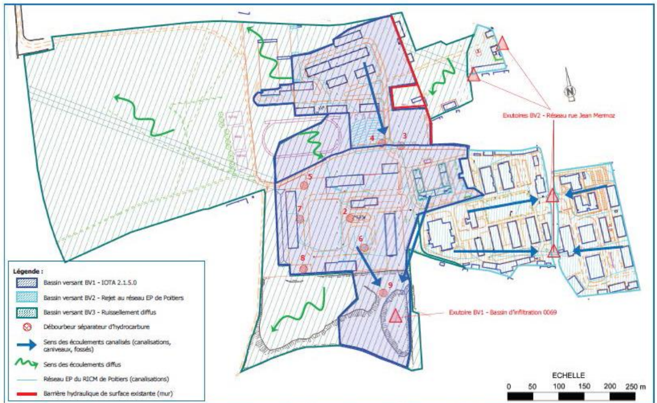
Figure 3 : Bassins versants principaux du RICM – Quartiers Ladmiraat et Vieille Chauvinière de Poitiers
