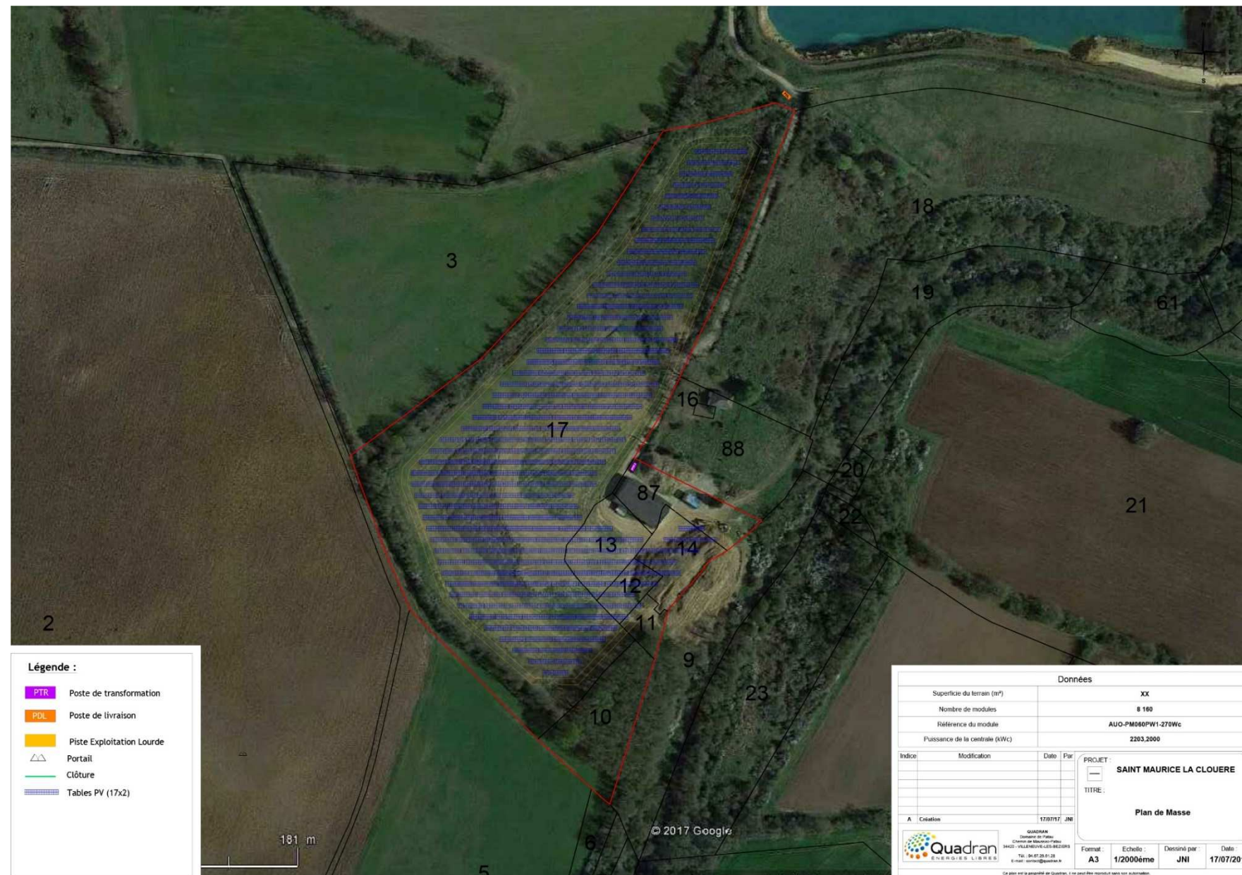
Plan masse d'implantation des tables photovoltaïques
