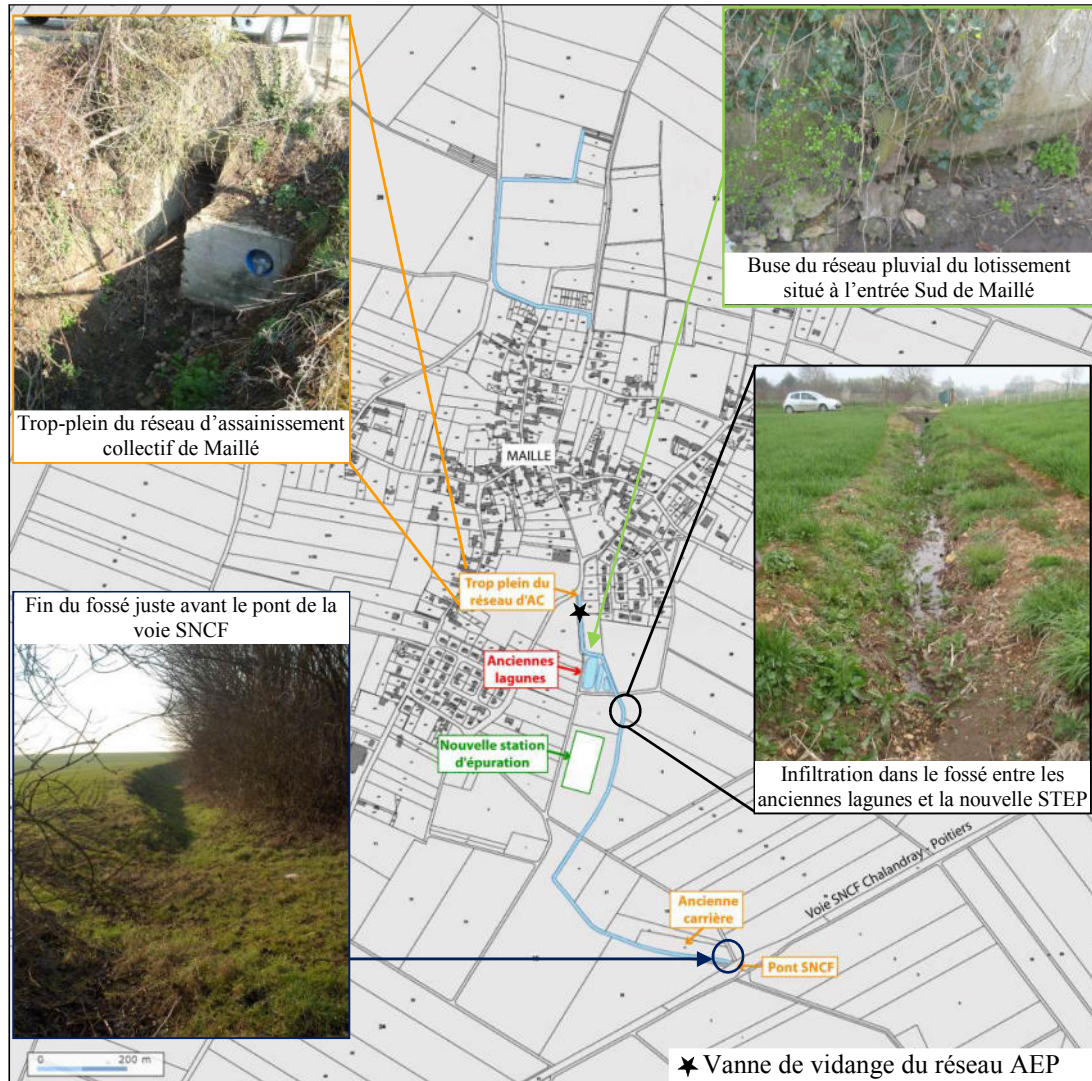
Figure 56 : localisation des différents points d'infiltration suspectés
