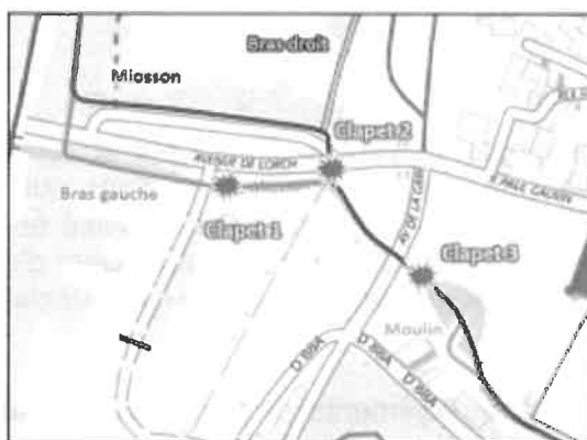
Figure 3 : Situation des trois clapets – Source : Fond de plan Géoportail
