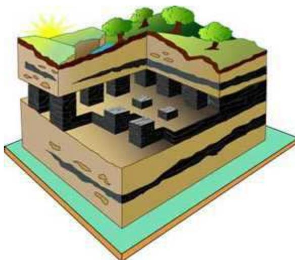
Figure 4 : Schéma du principe d'une exploitation par chambres et piliers abandonnés ([paca.developpement-durable.gouv.fr](http://paca.developpement-durable.gouv.fr))
